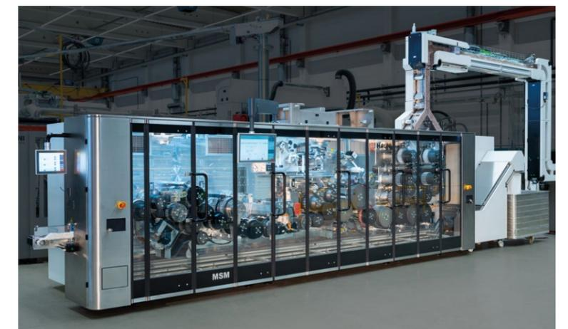
Mit dem modularen und flexiblen MSM hat Hauni eine Maschine im Portfolio, die sich auf die Produktion umweltfreundlicher Filterlösungen ausrichten lässt.
